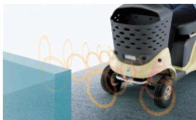
正面の壁や太いポールなどの前方の障害物をセンサーが検知すると、運転者に警告し、車両を減速することで、安全運転をサポートする機能です。
