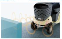
正対する壁や太いポールな どの前方の障害物をセンサ ーが検知すると、運転者に 警告し、車両を減速させる ことで、安全運転をサポー トする機能です。
