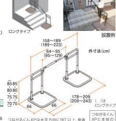
つながるくんXPは水平方向に90°以上、垂直 方向は45°まで曲げることができます。(段差高さ45cm (ロングタイプ64cm)まで) ●重量/38.8kg(ロングタイプ39.1kg)
